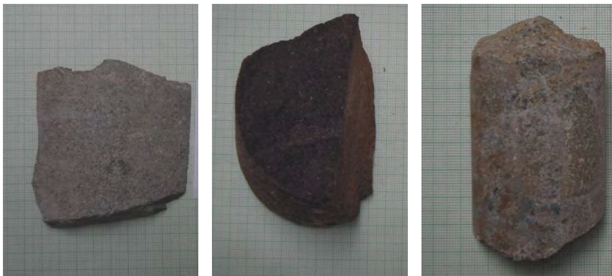
Obr. 7. a) Propylitizovaný dioritový porfýr (D-12; 80,9 m), b) čerstvý dioritový porfýr (D-12; 120,9 m), c) lávová brekcia propylitizovaného andezitu (D-13; 29,9 m). Vzorok vrtných jadier sú položené na milimetrovom papieri.
