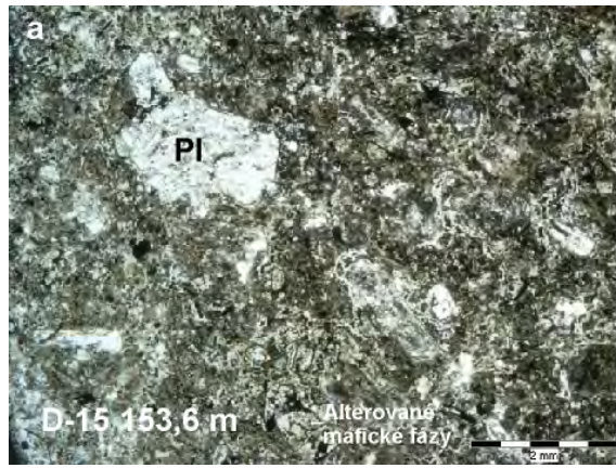
Obr. 10. a) Mikrofotografia vzorky D-15 153,6 m (rovnobežné nikoly), b) mikrofotografia vzorky D-15 219,0 m (rovnobežné nikoly). Pl – plagioklas, Qtz – kremeň.
