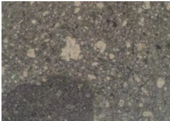
Obr. 9. a) Intenzívne alterovaný andezit brekciovitého charakteru (D-15; 153,6 m), 2x zväčšené, b) alterovaný dacit (D-15; 219,0 m), 3x zväčšené. Na fotografiách sú odrezky z horniny s veľkosťou 4 x 3 cm, použité na výrobu výbrusu.
