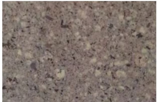
Obr. 9. a) Intenzívne alterovaný andezit brekciovitého charakteru (D-15; 153,6 m), 2x zväčšené, b) alterovaný dacit (D-15; 219,0 m), 3x zväčšené. Na fotografiách sú odrezky z horniny s veľkosťou 4 x 3 cm, použité na výrobu výbrusu.
